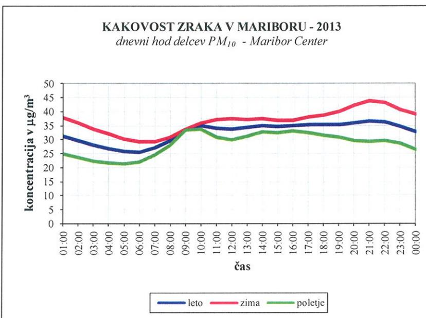
**Slika 5.17:** Dnevni hod koncentracij delcev PM<sub>10</sub>, merilno mesto Center
