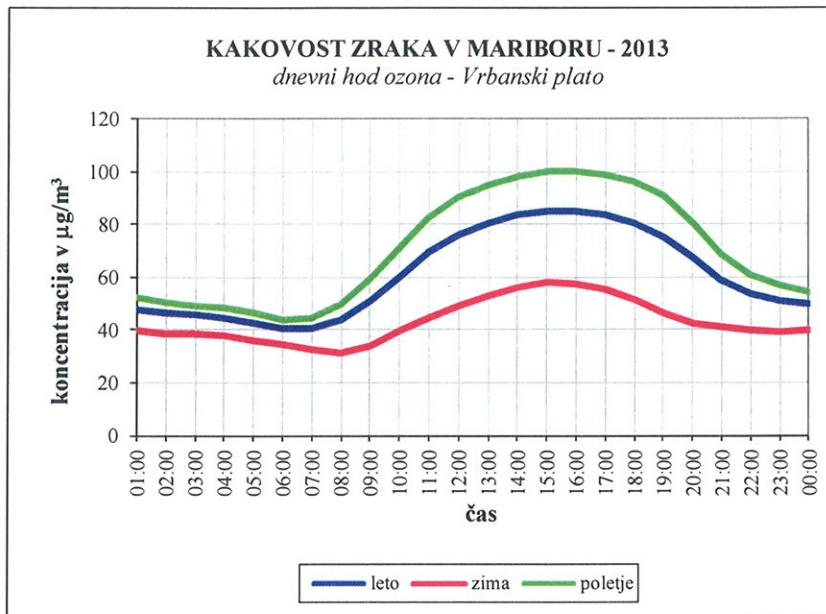
**Slika 5.12:** Dnevni hod O<sub>3</sub>, merilno mesto Vrbanski plato
