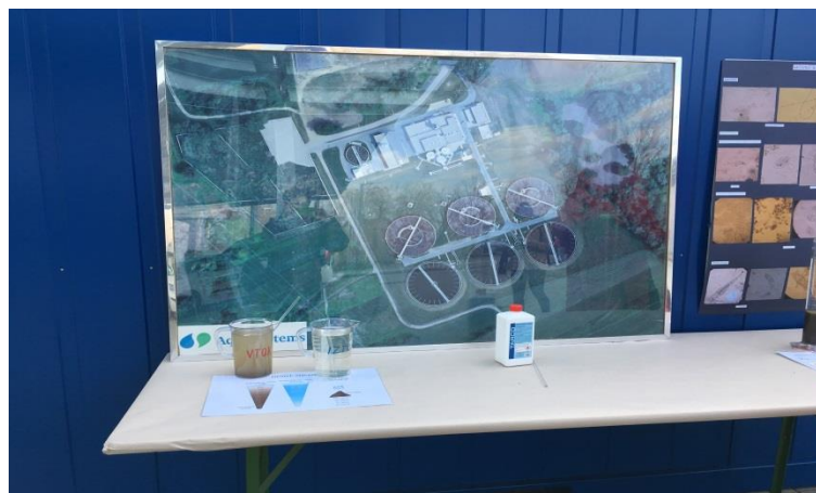
Shema Centralne čistilne naprave ter vzorci vtoka odpadne vode in iztoka prečiščene vode
