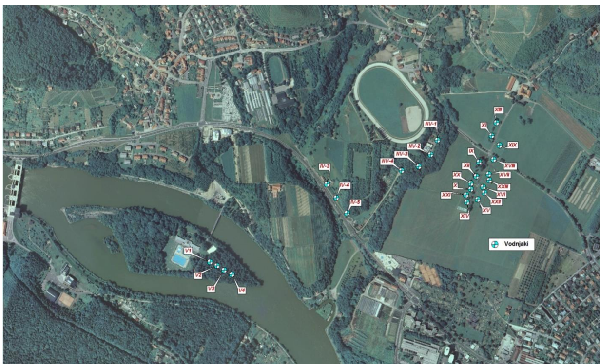
Slika 4.4.1.3: Črpalni in nalivalni vodnjaki v okviru celotnega sistema z umetnim bogatenjem črpališča Vrbanski plato
