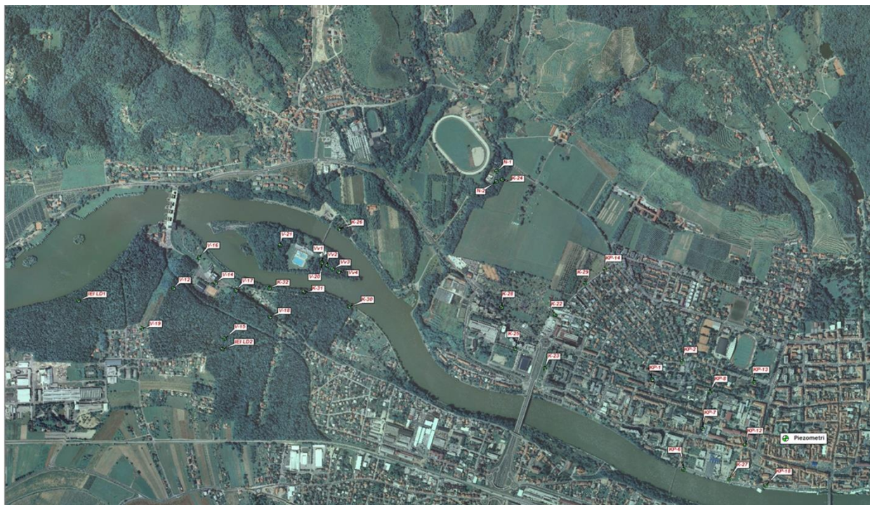
Slika 4.4.1.4: Sistem piezometrov na območju vodonosnika Vrbanski plato
