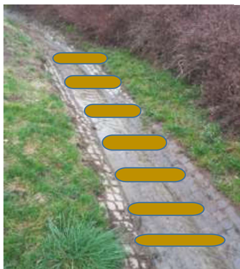
Slika 21. Shematski prikaz vgradnje hlodov v kanaliziran vodotok
