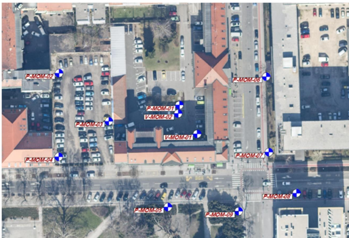
Slika 5.11: Lokacije izvedenih piezometrov in črpalnih vodnjakov na območju MOM (Blažeka et al., 2018)
