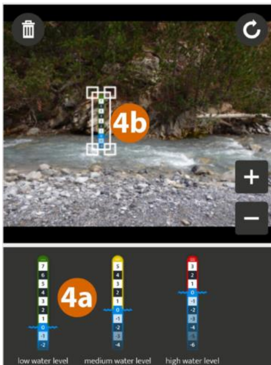
Slika 6.3: Primer uporabe meritev s pametnimi telefoni in elektronsko postavljeno merilno lato (CrowdWater)
