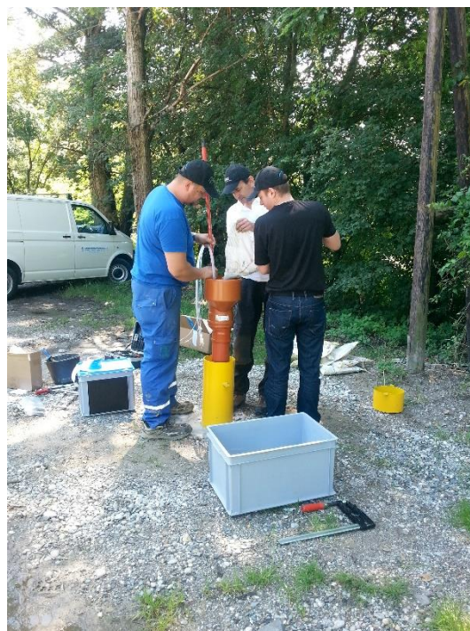
5.12: Globinsko orientirane meritve – sistem v piezometru PGo-1 na levem obrežju reke Drave nasproti Mariborskega otoka
