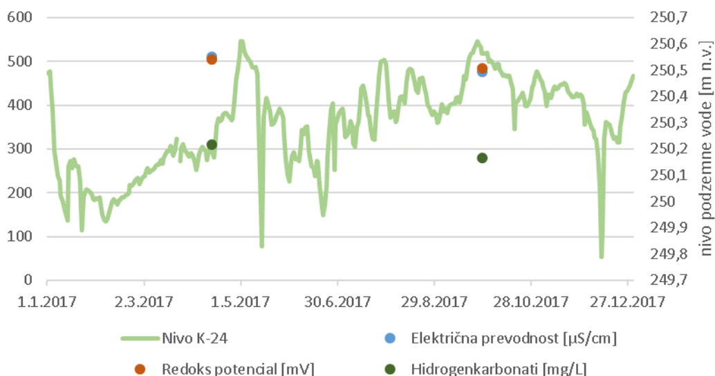
Slika 26: Grafični prikaz nihanja nivoja podzemne vode (m n.v.) v povezavi z vrednostmi osnovnih parametrov (redoks potencial, električna prevodnost, hidrogenkarbonati) na merilnem mestu K-24 v letu 2017.
